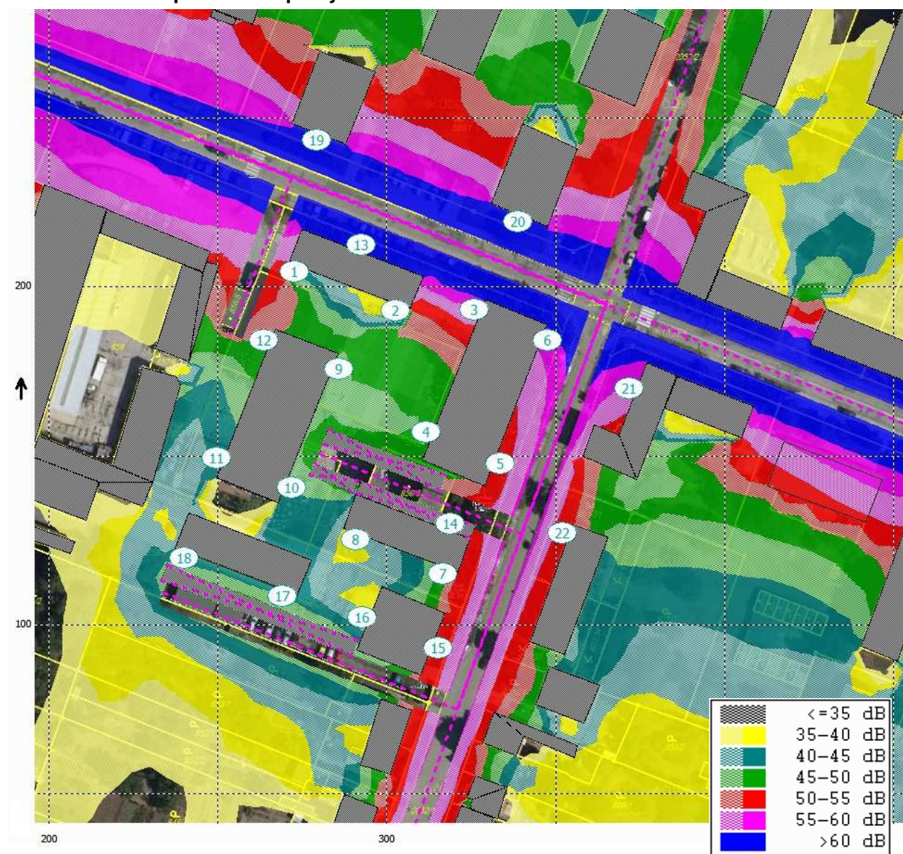
Obr. 8.1: Hluková mapa pro den, izofony vykresleny ve výšce 5 m nad terénem – automobilová doprava 2020 po výstavbě souboru
